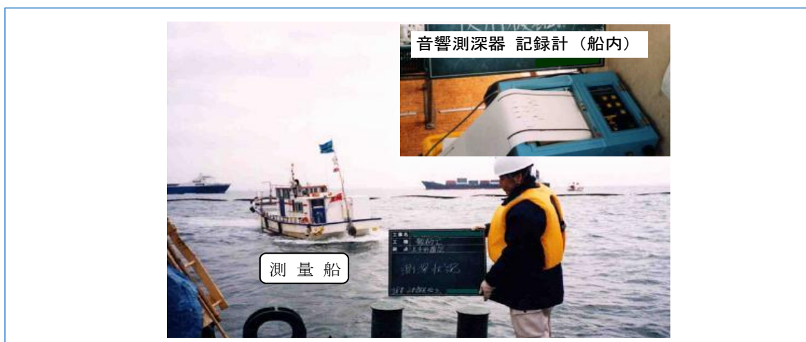
ず げんば しんせんそくりよう 図-31 現場の深浅測量の ようす
