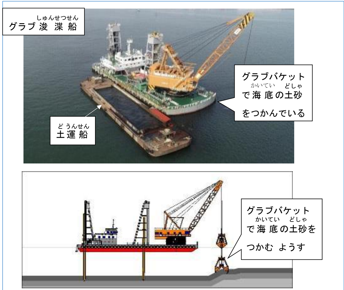
ず しゅんせつせん 図ー15 グラブ浚渫船
