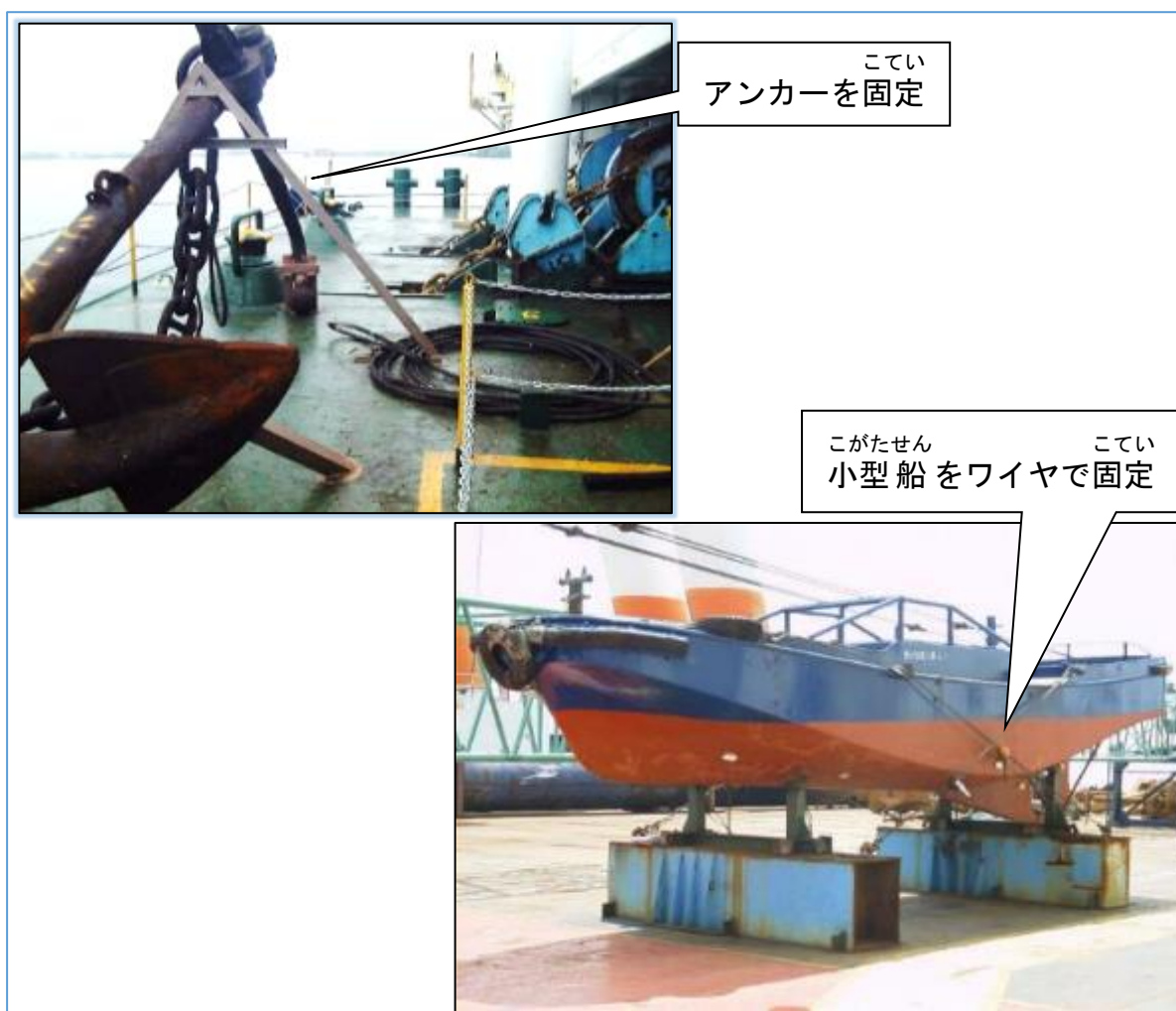
図-124 作業船に積みこんだ機材の固定のようす
