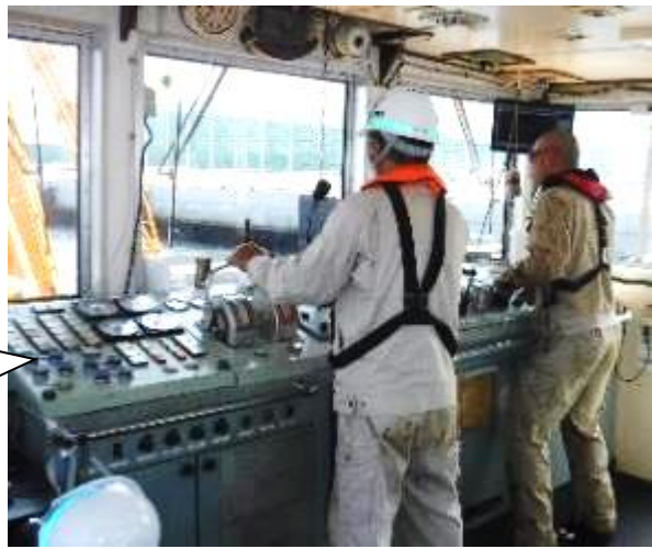
ず 図－137 揚錨船のウインチ操作によるアンカーの つり上 そう さ あ げ、下ろしの ようす
