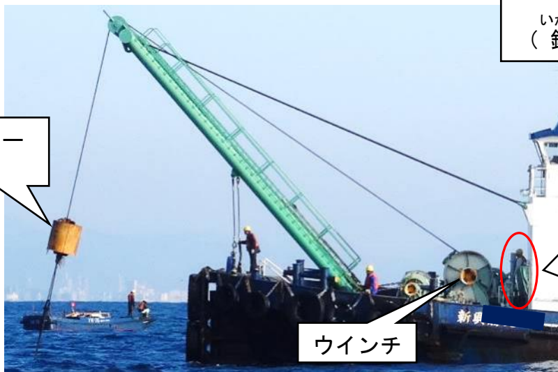
図-158 ウインチ操作によるアンカー(錨)の 巻き上げ作業のようす
