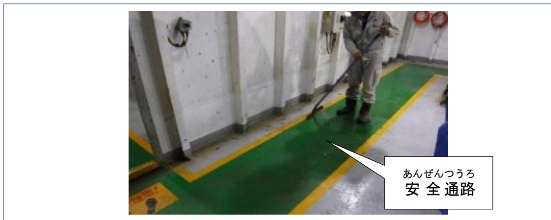
ず さぎようせん こうはん あんぜんつうろ てんけん せいそう 図-113 作業船の甲板の安全通路の点検と清掃の ようす
