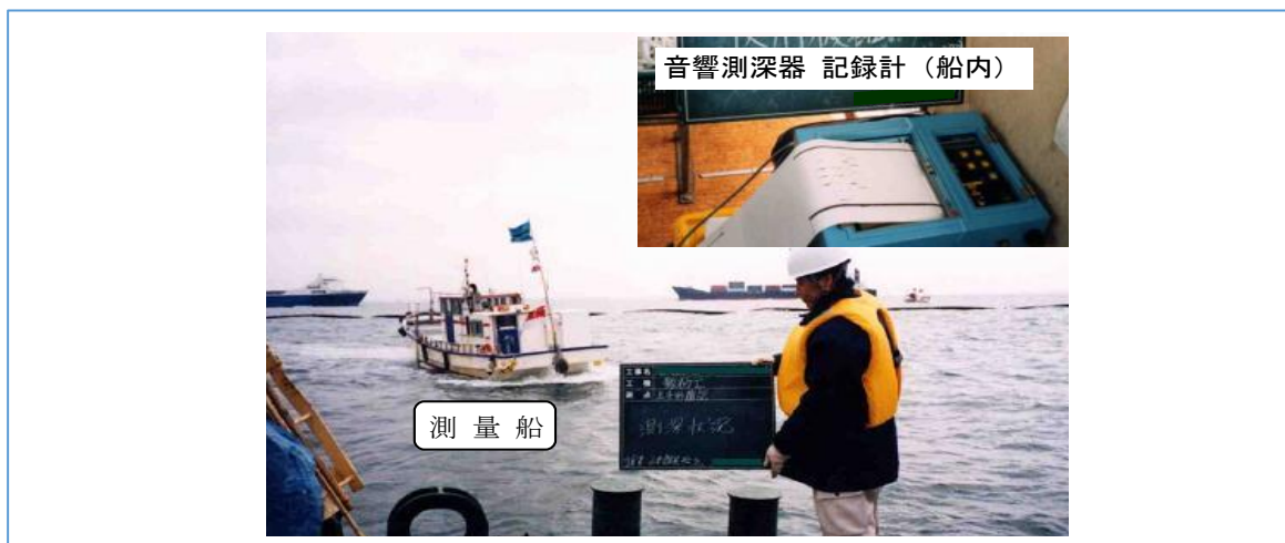
図-31 現場の深浅測量のようす
