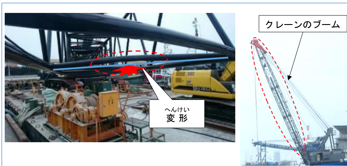
ず かたち か れい 図－117 形が変わったクレーンのブームの例
