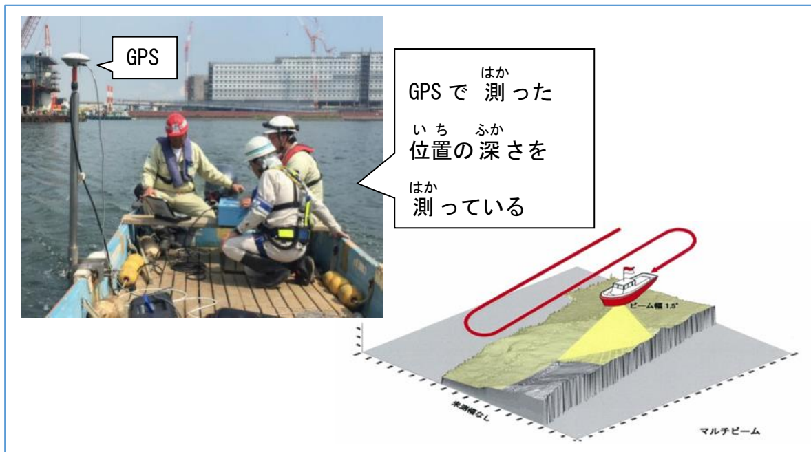
ず つか ふか そくりよう 図－102 ソナーを使った深さの測定の ようす
